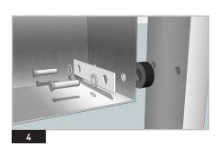
**5)** zur montage des schlosses stecken sie es in das vorgesehene loch in der klappe. prüfen sie ob der riegel beim schließen nach oben zeigt, das schloss wird mit der gabelförmigen montagezunge von innen durch aufschieben der zunge befestigt.
